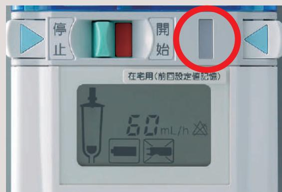
※電源が入った状態で、ポンプが停止している時は、流量の数値が点滅しています。
