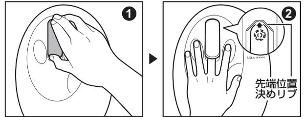
右手で指クリップ部を開け、左手の中指を図②のように先端位置決めリブに指の先端が軽く接触するまで挿入して指クリップ部を閉じます。
