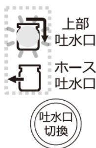
吐水口切換ボタンを長押しして切り換えます。
