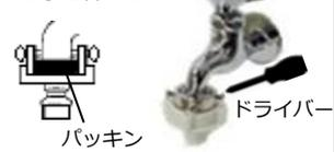
・説明ラベルをはがしてから、継手下のボディを右に回し、ねじ山が1~2mm程度になるまで、しっかりと締めてください。
