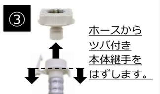
(注意) この場合は、蛇口接続用給水栓継手ははずし、ホースを直接取り付けください。
